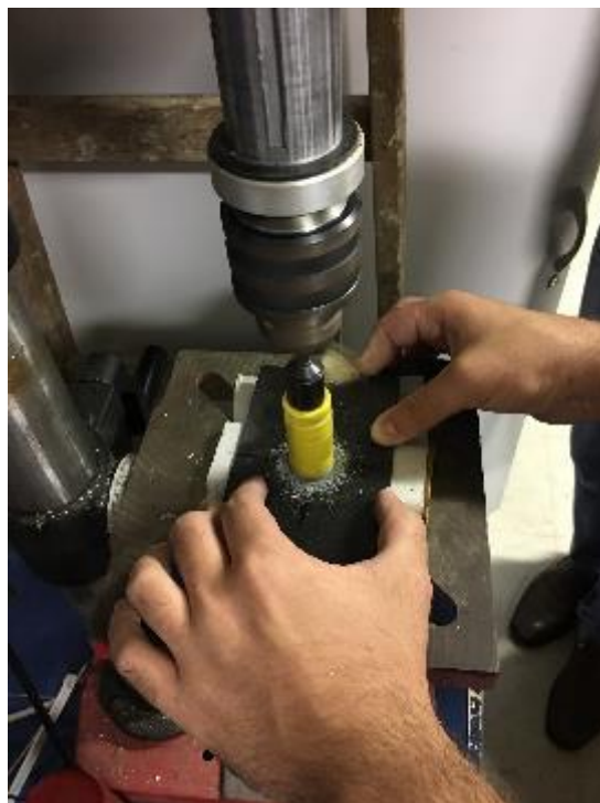
Figura 39 - Furo na dimensão final.
