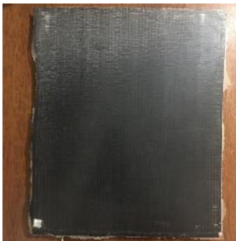
Figura 34 - Configuração final da placa de fibra de carbono/epoxi.
