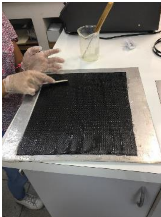
Figura 32- Aplicação do epóxi.
